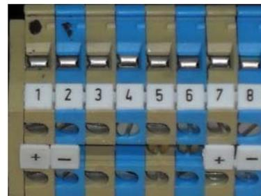
Im Auslieferungszustand sind die Anschlüsse 5 + 6 gebrückt.
